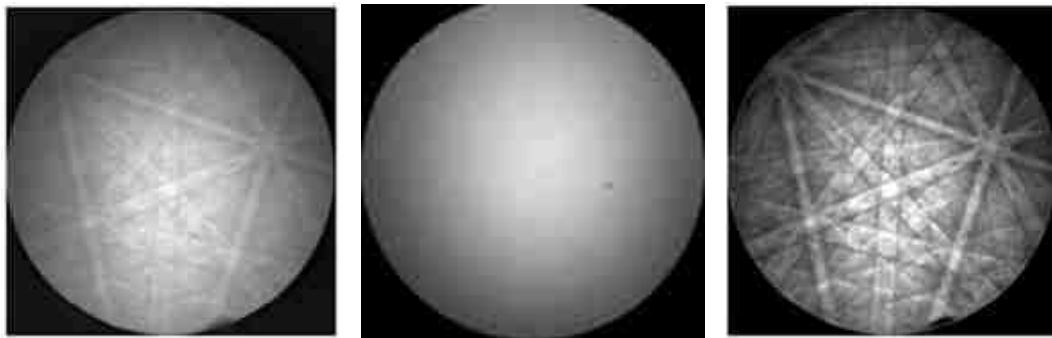
Fig. 4 – Diagrammes de diffraction – brut, bruit de fond et bruit de fond soustrait, respectivement.
