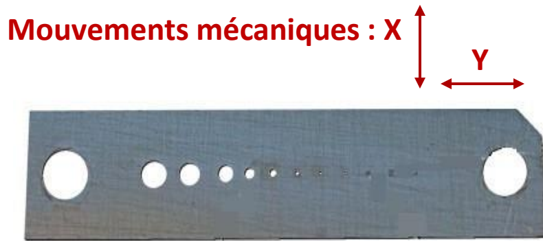
Barrette de diaphragmes : trous de 20 \mu\text{m} à 900 \mu\text{m}
