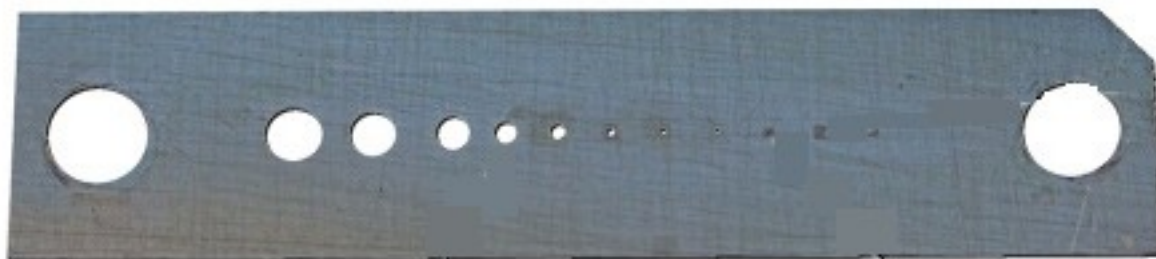
Barrette de diaphragmes permettant la sélection de l'intensité du faisceau d'ions
