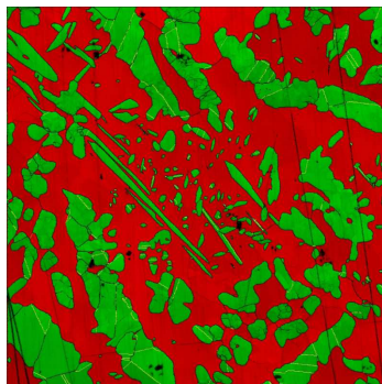
Acier duplex austénite (FCC) - ferrite (BCC) différentiation des phases.
