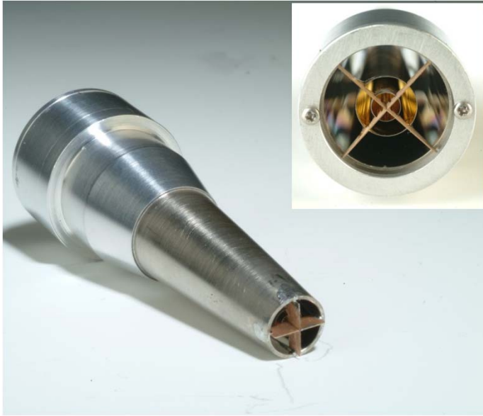
optique de focalisation à miroirs concentriques (jusqu'à 2.5 KeV environ)
