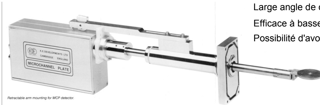
Détecteur MCP "Microchannel Plates" (document KE)
