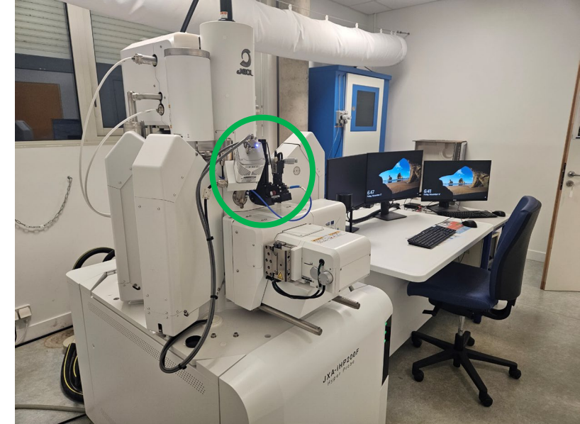
Cathodoluminescence hyperspectral spectromètre (résolut. 210 – 970 nm) (Czerny-Turner symétrique)
