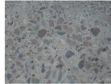
Béton : Ciment + sable et gravier
