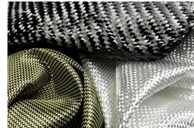
Tissus : fibres de carbone, de kevlar et de verre
