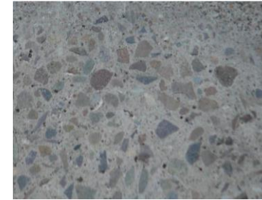
Béton : Ciment + sable et gravier
