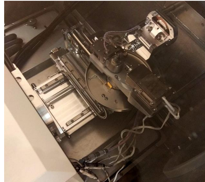
Placement sur la platine du MEB/FIB
