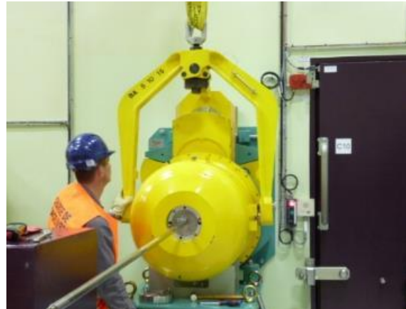
Accostage du conteneur sur la cellule et transfert de l'échantillon
