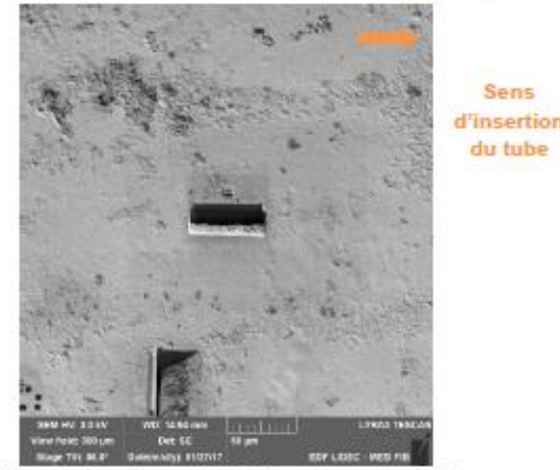
Figure 99. Vue d'ensemble de la cross-section CS3.
