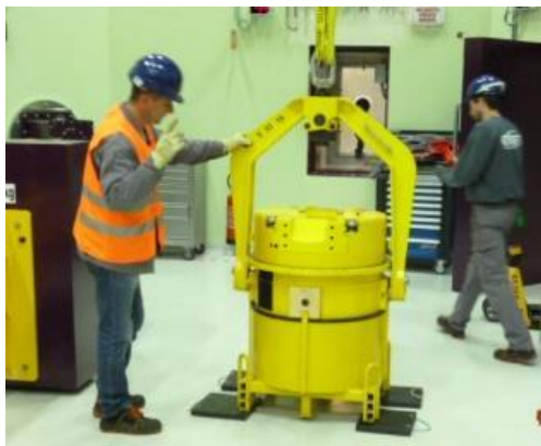
Levage du conteneur pour accostage sur la cellule
