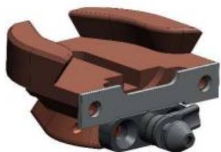
"Cryo carrier puck (Cu)" refroidi @ 30K dans la chambre d'analyse
