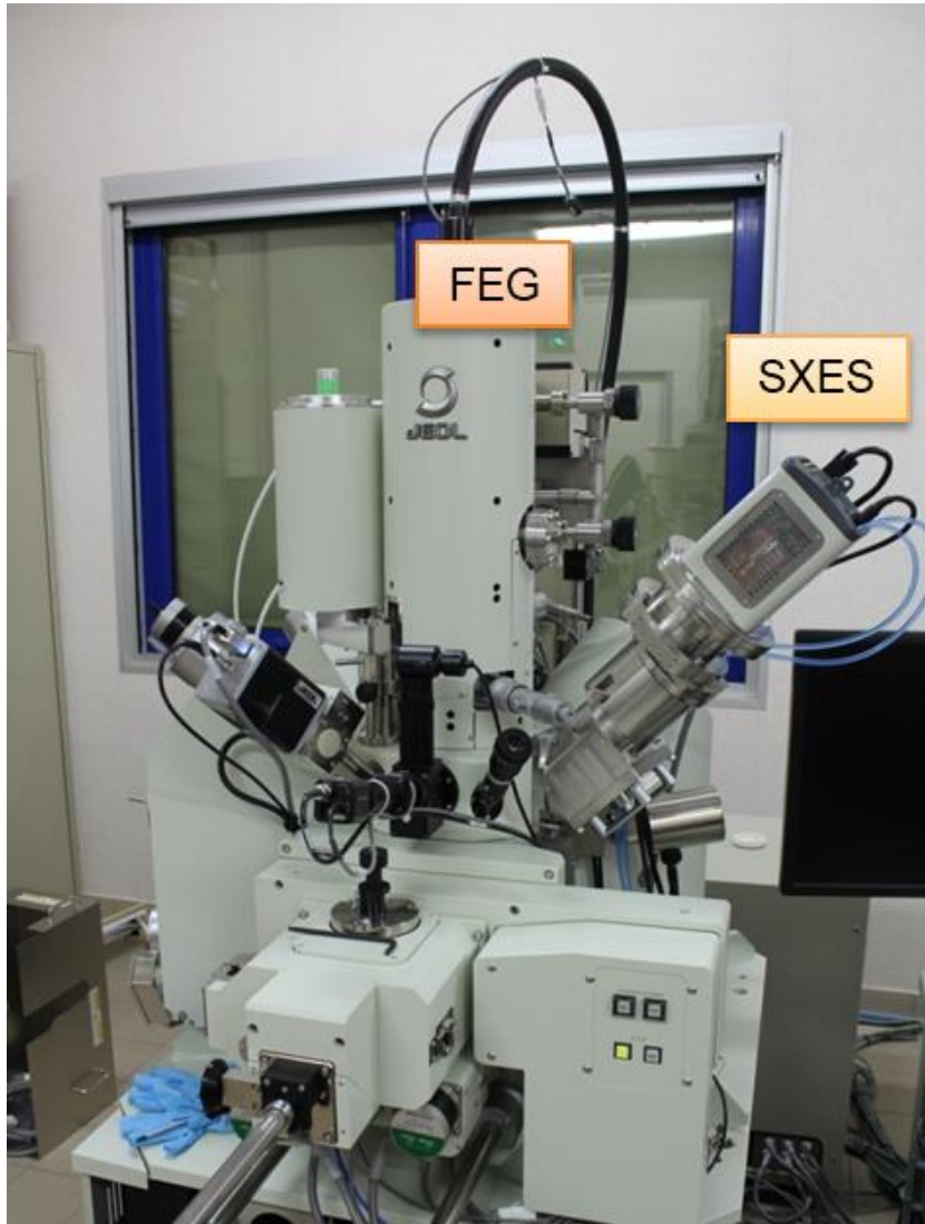
Ce détecteur n'est disponible que sur MET, MEB et Microsonde JEOL
