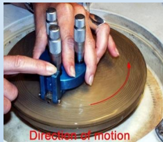
Série de disques plastifiés diamantés (0,5, 1, 3, 6, 15 µm)
