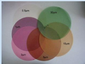
Série de disques plastifiés diamantés (0,5, 1, 3, 6, 15 µm)
