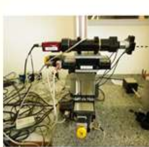
Microscope piloté par 4 platines motorisées
