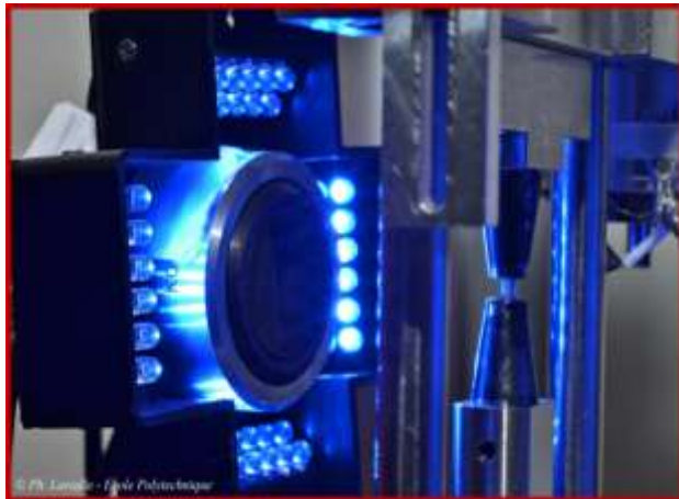
Microscope piloté par 4 platines motorisées
