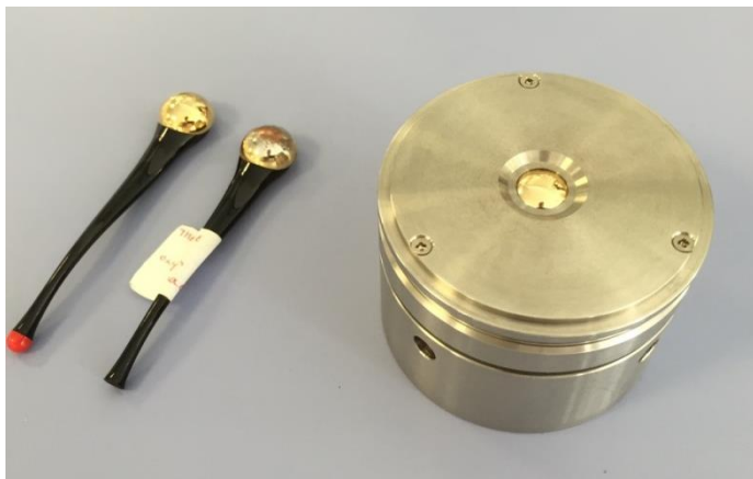
Montage des échantillons dans le porte-échantillon
