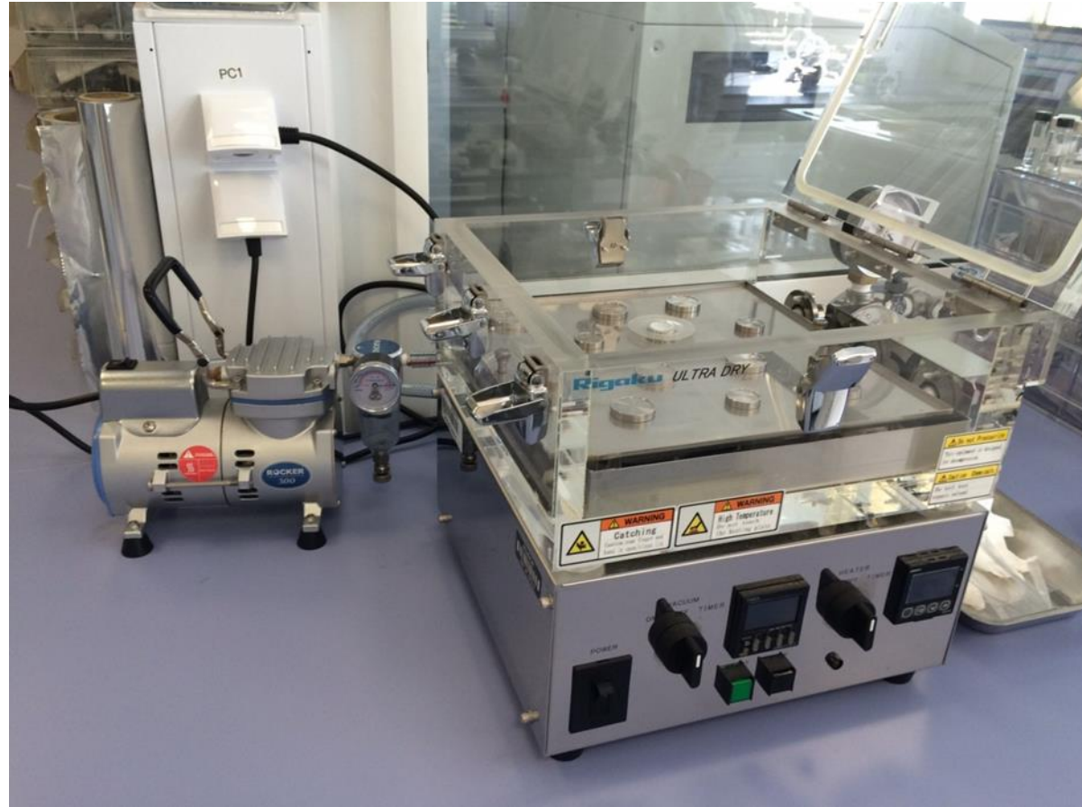
Puis séchage de l'échantillon sous vide primaire
