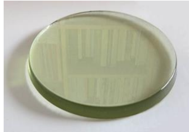
Obtention d'une pastille manipulable pour l'analyse Poids de la pastille : 7g
