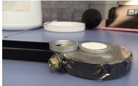
Aperçu du compactage de l'anneau sous 5 à 10 T de pression.
