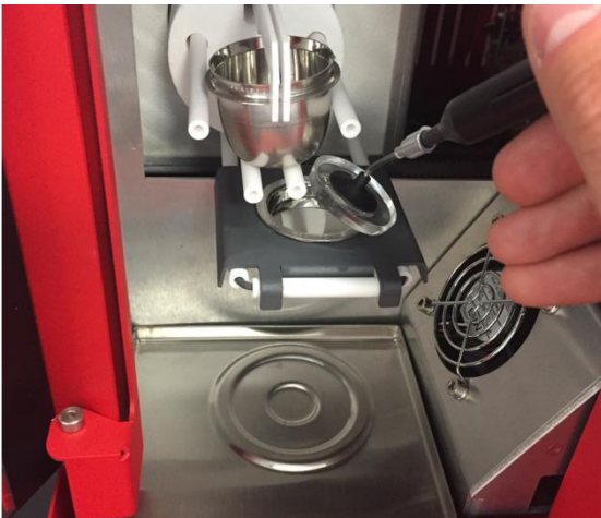
Récupération de la pastille refroidie
