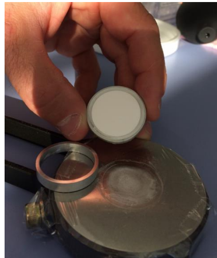
Obtention d'une pastille manipulable pour l'analyse
