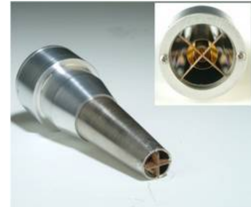
optique de collimation à miroirs concentriques (jusqu'à 2.5 KeV environ)
