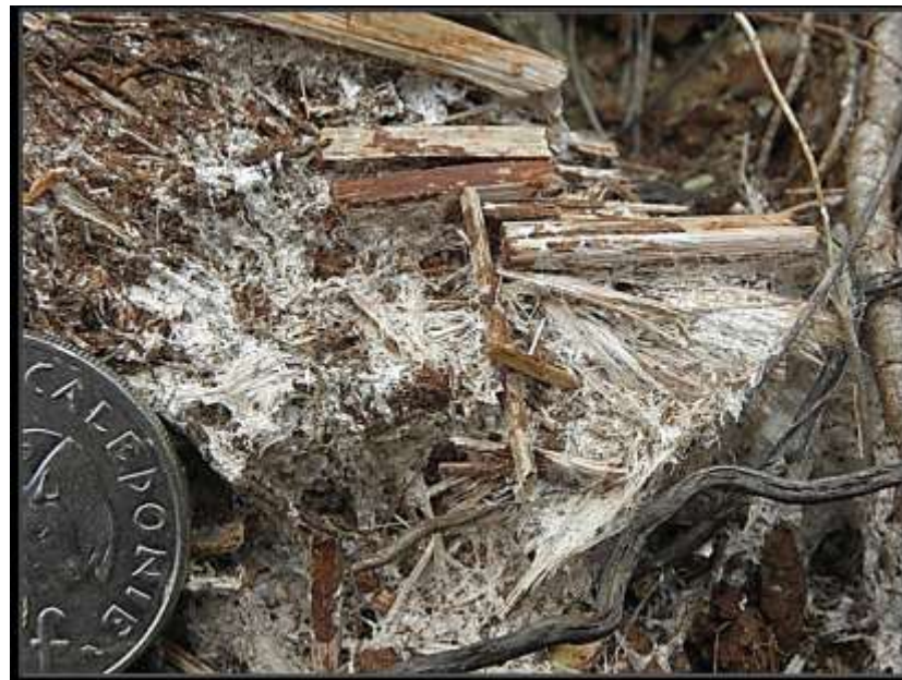
Plan à anthophyllite très altéré, montrant la coexistence de fibres rigides et de fibres souples (Presqu'île de Bogota)
