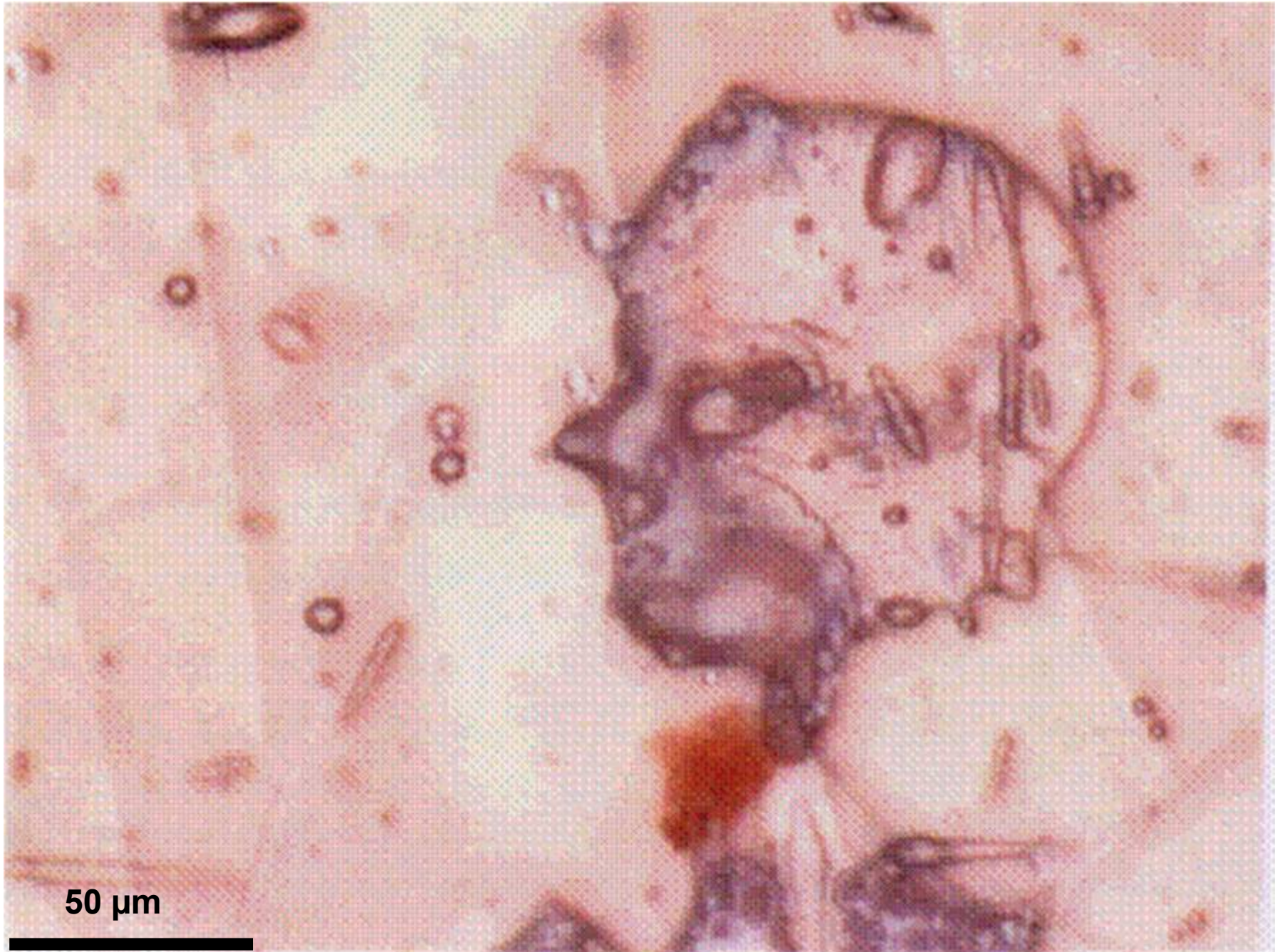
Lamelle d'alumine sur une couche d'Alumine déposée par PECVD
