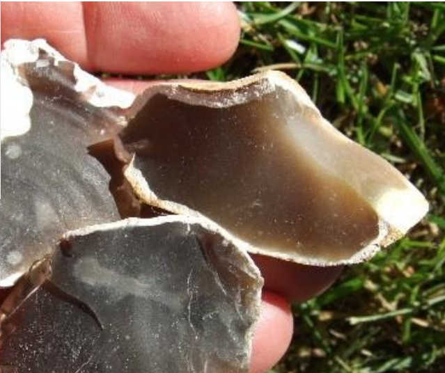
Faciès de rupture « conchoïdal » d'un matériau fragile , le silex
