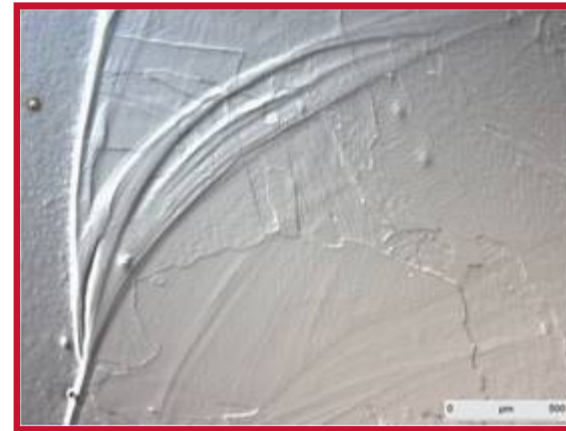
Alliage de soudure à base de Nickel après finition OPS vibrant une nuit
