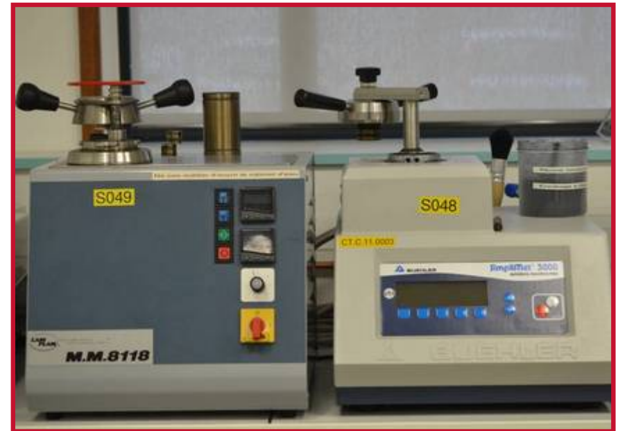
Equipements pour enrobage à chaud (diamètre 25 et 40 mm hauteur 5 mm) 290 bar 180°C
