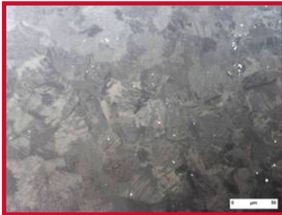
Alliage de Zr après finition OPS + H 2 O 2 + HF
