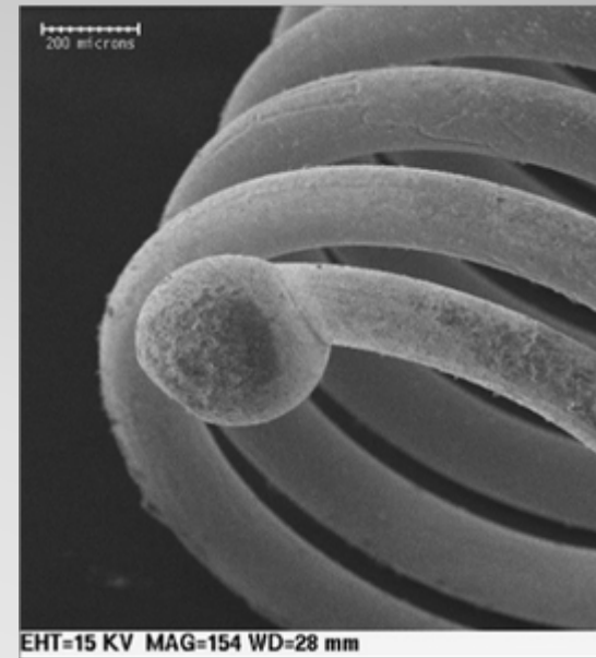
Rupture à chaud
