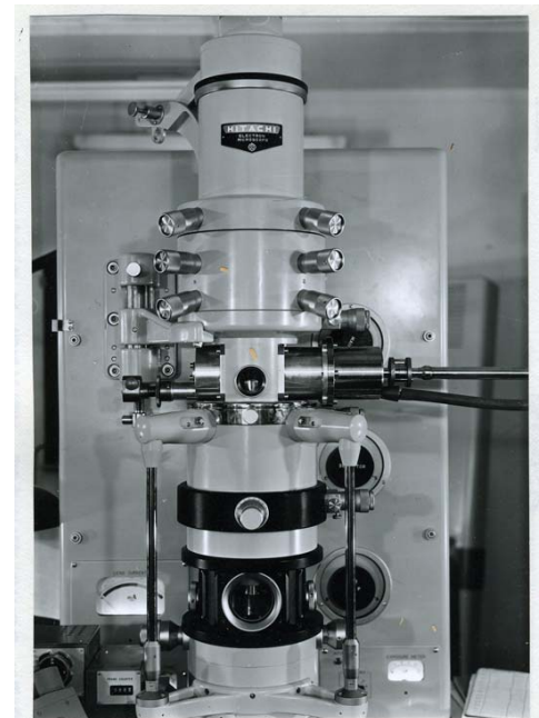
Cliché 1 : Le porte-objet inclinable refroidi à l'hélium liquide en place sur le microscope
