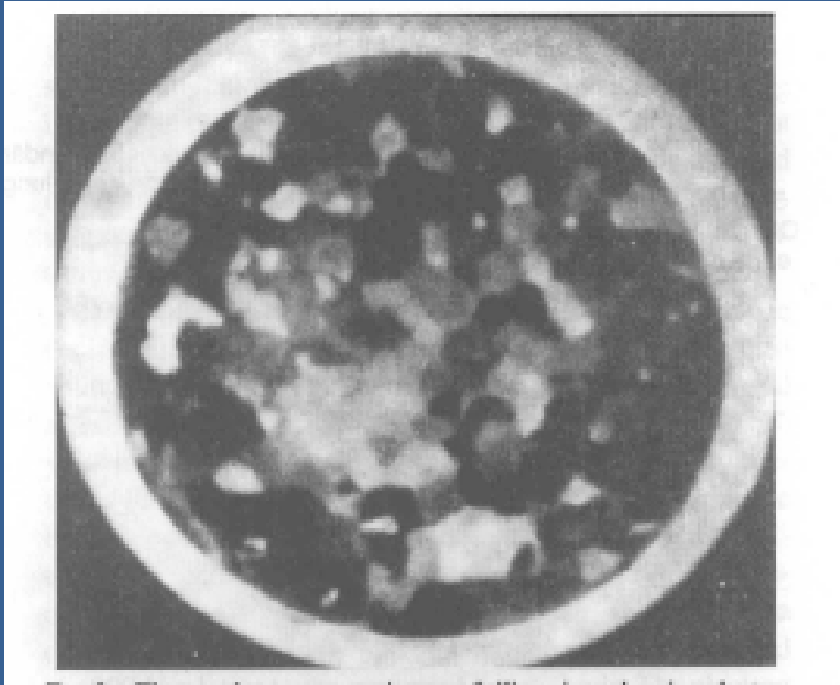
Image obtenue par Knoll en 1935 sur un échantillon de Fer-silicium montrant un contraste de canalisation dimension de la zone observée : 50 mm
