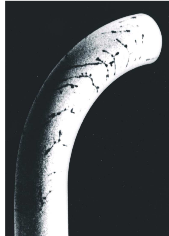
tube de générateur de vapeur fissuré en service par CSC dans sa partie coudée (contrainte)
