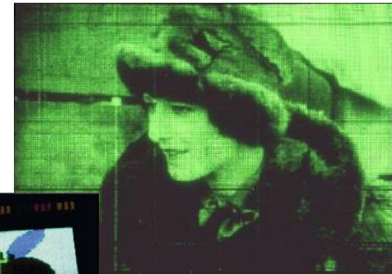
Écran 6", CEA- LETI (2005). Écran monochrome définition 320×240, taille de pixel 350μm, luminance 800 Cd/m 2
