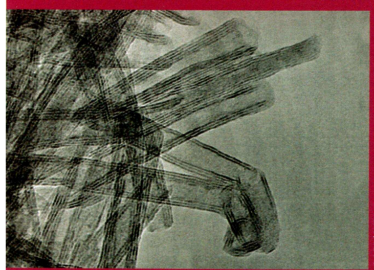
Image par microscopie électronique à très haute résolution de nanotubes d'oxyde de titane.
