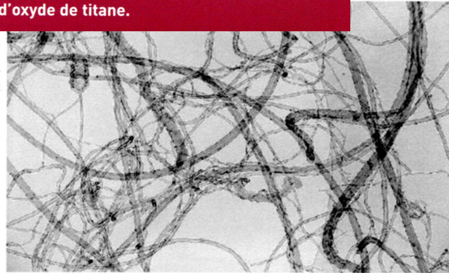
Nanotubes de carbone vus par microscope électronique à transmission.
