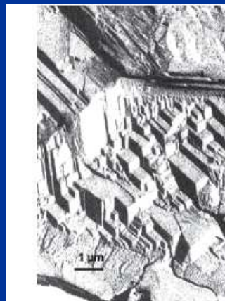
Figure 2. Réplique d'un cristal d'alumine enchâssé dans une phase vitreuse. Réplique directe avec ombrage au platine. P. Peter EOST Strasbourg.
