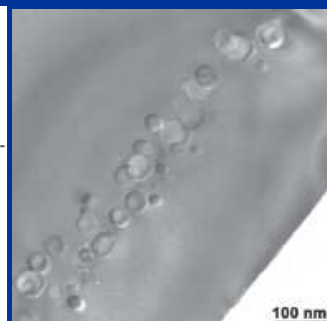
Figure 33. Échantillon de silicium avec implantation de He (cavités) sous la surface. Image TEM en champ clair. J. Werckmann, IPCMS, Strasbourg.
