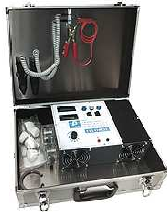
Appareil de polissage et d'attaque électrolytique aux tampons pour laboratoire ou travail « in situ ».
