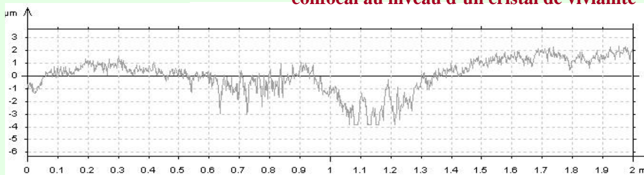
Mesure de profil réalisée sous un cristal de vivianite au microscope confocal
