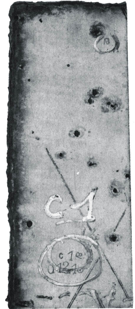
Figure V.1.1. - Corrosion par piqûre d'un acier inoxydable austénitique à 18% Cr et 10% Ni en milieu chloruré (environ 200 ppm \text{Cl}^- ) contenant probablement des espèces sulfurées.
