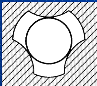
Trou trifolié (1400 MW) (pour tubes f 19,05 mm)
