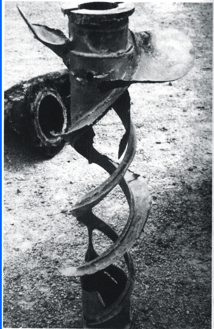
Figure V.1.3. - Érosion-corrosion d'un agitateur en acier inoxydable à 20% Cr, 25% Ni, 4,5% Mo et 1,5% Cu en milieu phosphorique contenant des particules abrasives (silice et gypse) et des impuretés (chlorures et fluorures).
