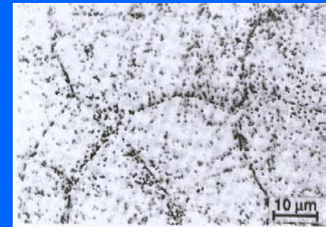
fortes précipitations de carbures intragranulaires
